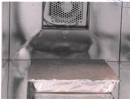
Bild 3: Prüfstück in der 200 L Emissionsprüfkammer.
