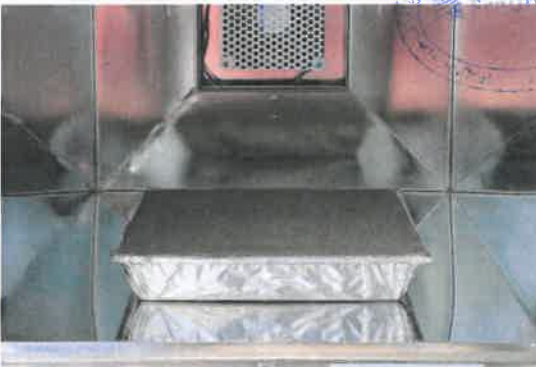
Bild 3: Prüfstück in der 200 L Emissionsprüfkammer.
