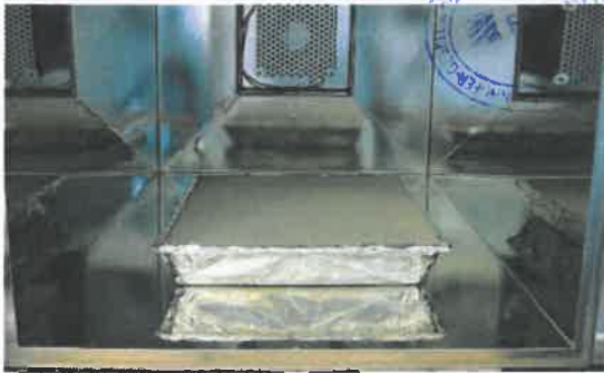
Bild 3: Prüfstück in der 200 L Emissionsprüfkammer.
