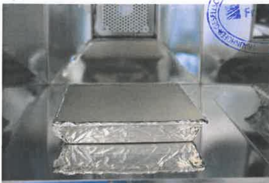
Bild 3: Prüfstück in der 200 L Emissionsprüfkammer.
