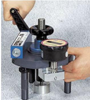
Die Prüfung der Oberflächenzugfestigkeit dient nur zur grundsätzlichen Abschätzung der Untergrundqualität. Die Messungen werden stets am fertig vorbereiteten Untergrund durchgeführt.
