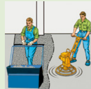
Auflegen der Hartkornmischung SILATEX® HZ-Spezial
