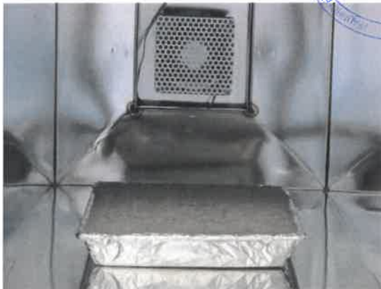
Bild 3: Prüfstück in der 200 L Emissionsprüfkammer.
