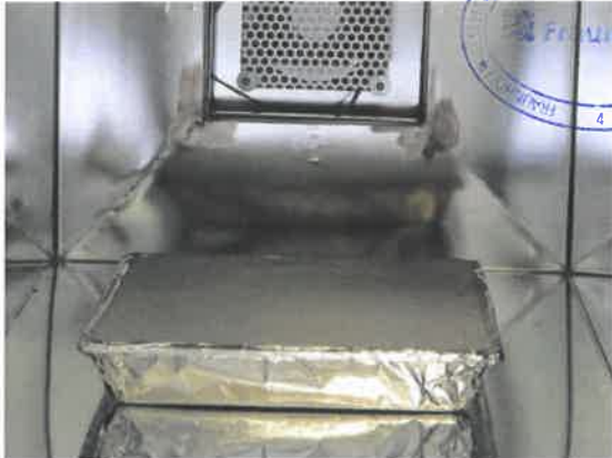
Bild 3: Prüfstück in der 200 L Emissionsprüfkammer.
